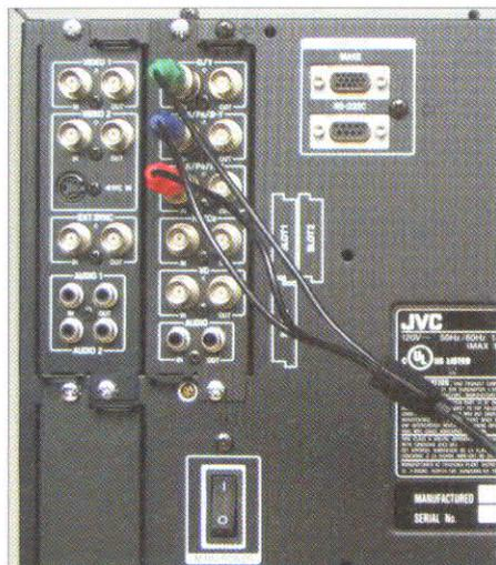
Alle Anschlüsse sind beim JVC optional. Für die drei Slots stehen von Composite bis zum HD-SDI Board vier Anschlußmodule zur Auswahl.
