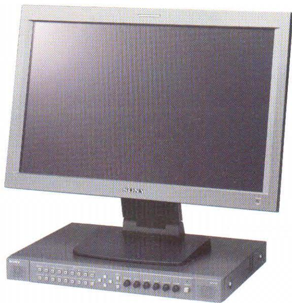
**Sonys neue LMD-Serie trennt LCD-Display und Basisstation voneinander. Das 23-Zoll-LC-Display LMD-230W im merkwürdigen 15:9-Format liefert eine Auflösung von 1.280 x 576 Pixeln. Brillanz und Kontrastvermögen lassen allerdings einiges zu wünschen übrig.**
